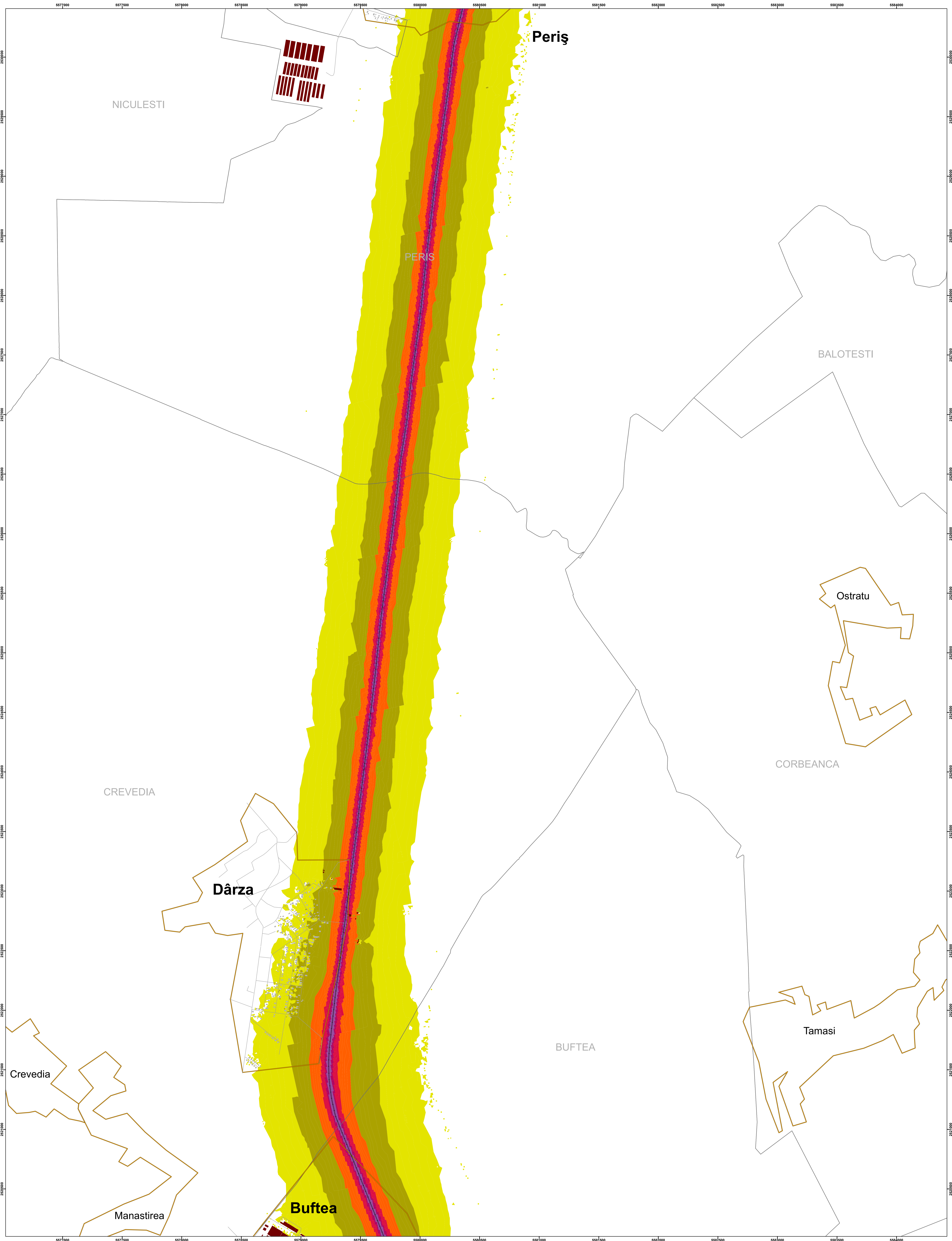
Hartă strategică de zgomot pentru căi ferate principale cu un trafic mai mare de 30000 treceri/an Strategic Noise Map for Major Railways Traffic over 30000 passes by year
