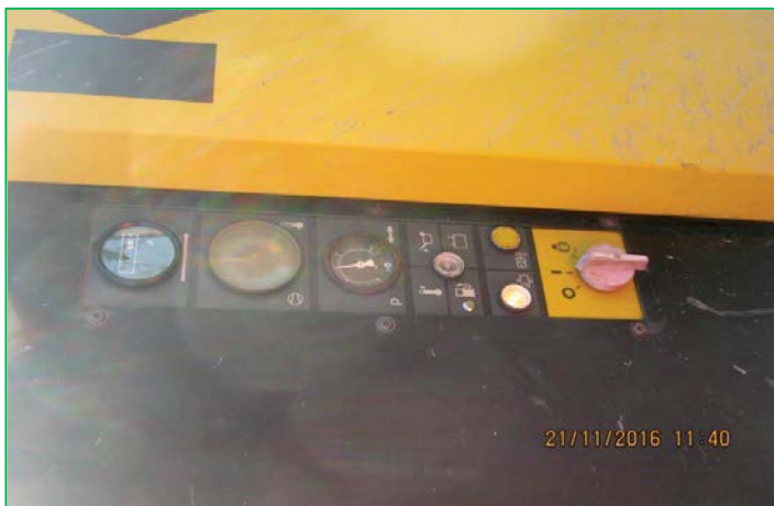
Panoul de comandă al dispozitivului pentru suflat cablu cu FO distanța Cliciova - Coșteiu Mare
